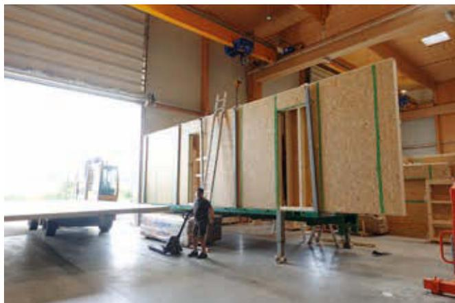
Eine fertige Holzrahmenbauwand.
