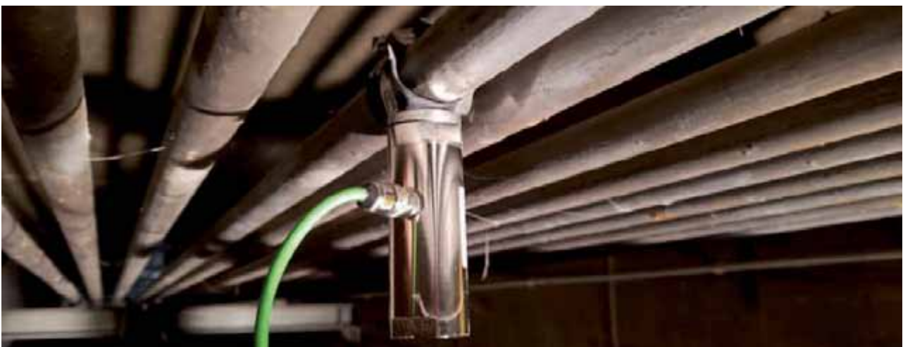
Abbildung 3: Am Spannglied montiertes Seismometer
