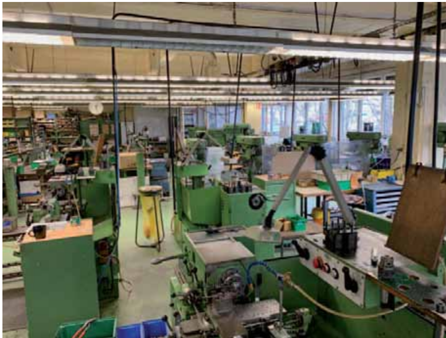
Abb. 5: Maschinenarbeitsplätze in einer Werkstatt mit flächiger Deckenbeleuchtung. Die feste Anordnung schwerer Maschinen schränkt die optimierte Ausrichtung von Lichtquellen gemäß ASR A3.4 ein. Foto: Jens Oehme
