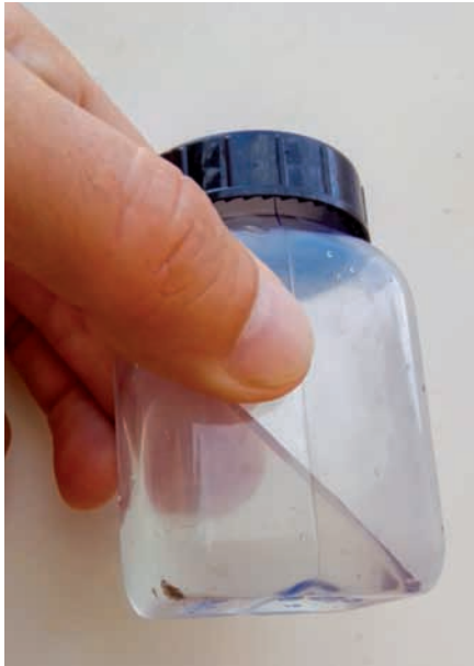
Abb. 3 Restsand aus 10m³ Wasser
