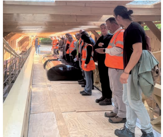
Einsatz der Baustellenbesucher für eine erneute Belastungsprobe am Brückenneubau.
