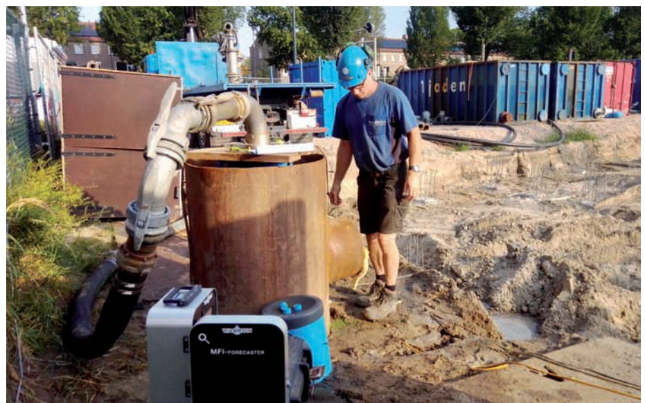
Abb. 4 Durchführung des MFI-Tests mit speziellem Testgerät
