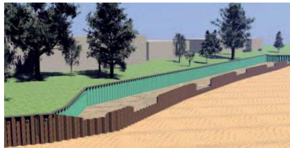
Auffüllen der Flachwasserzone bis Oberkante tiefste Öffnung
