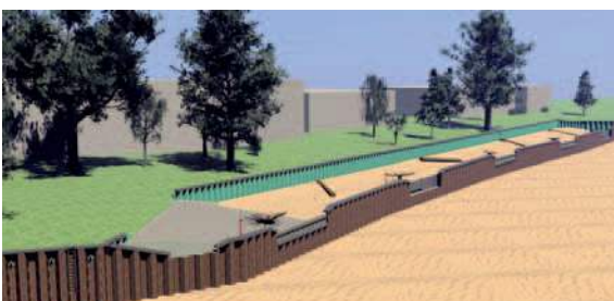
Abschneiden der Bestandsspundwand für den Tierausstieg und Totholzeinbau
