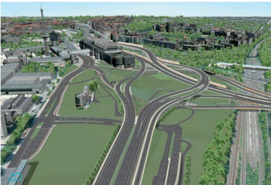
Die Grafik der neuen Verkehrsführung zeigt insbesondere die neuen Zu- und Abfahrten. Sämtliche Brücken im Planungsgebiet müssen erneuert bzw. ersetzt werden.
