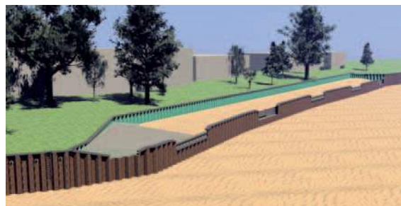
Kies und Sandeinbau sowie Modellierung der Böschungen
