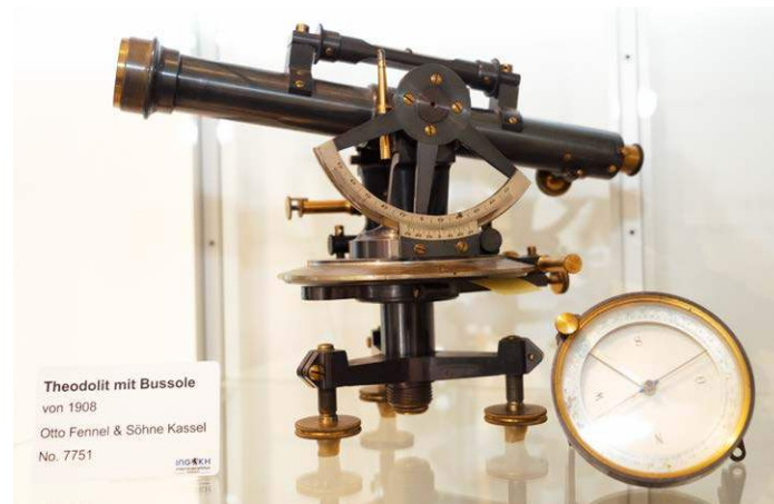
Einer der drei ausgestellten Theodoliten – dieses Exemplar ist zusätzlich mit einer Bussole ausgestattet.
