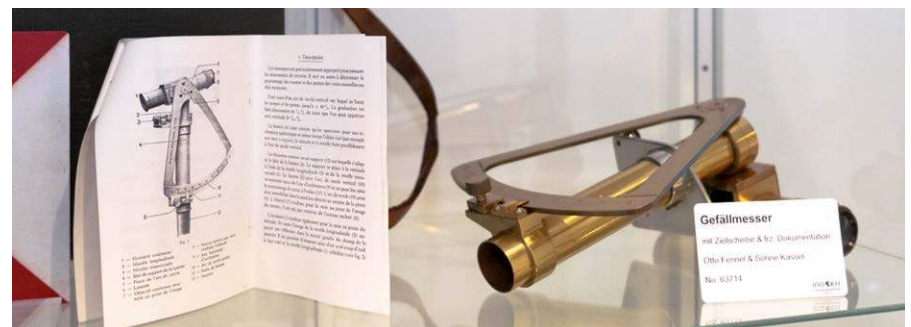
Auch ein Gefällmesser mit französischer Dokumentation und passender Zielscheibe ist Teil der Ausstellung. Foto: IngKH
