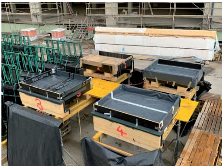
Abbildung 2: Die vier Modelle der HBV-Decken mit den gewählten Abdichtungsvarianten.
