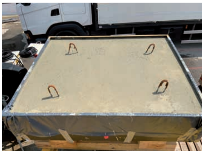
Abbildung 4: Modell kurz nach der Betonage
