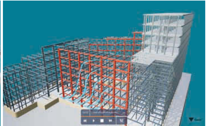
Bild 6 Shell-Haus Berlin, Screenshot Windlastabtrag
