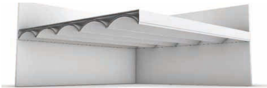
Abbildung 1: Skizze eines Deckensystems mit Tonnenschalen
