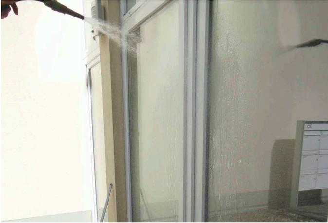
Abb. 3: Wasserversuche zeigten, dass das auf der Fassade auftreffende Schlagregenwasser durch...
