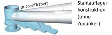
Stahlaulagerkonstruktion (ohne Zuganker)
