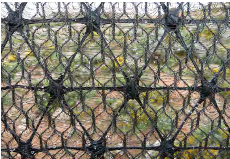
3 Wasser aus Nebel fischen: Die bionischen textilen Auffangnetze sollen künftig im großen Stil Menschen mit Trinkwasser versorgen.
