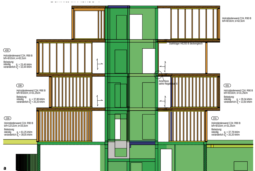
2a + b Wegen der unregelmäßigen Grundrisse mussten die Deckenlasten außer über die Holzrahmenbauwände (a) auch über Stahlstützen und -unterzüge abgetragen werden (b). Die größte Spannweite mit knapp 7,10 m befindet sich in der Mitte des 2. OG.
