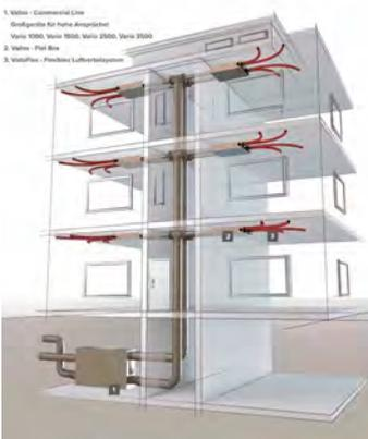
Die „Vallox Flat Box“ ist ein Luftverteilm modul, das für mehr Flexibilität bei der Frischluftzufuhr sorgen soll.
