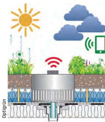
Die Retentionsbox „WRB 80F“ ist das Herzstück der Systemlösung „Retentionsdach Drossel“: Wasserrückhalt plus Begrünung
