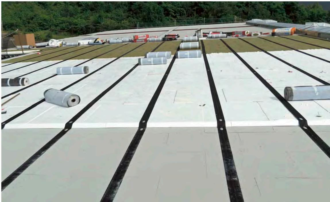
1 Dachaufbau für den Freilandversuch mit den Dämmstoffen Calostat, Porenbeton und Mineralwolle (von vorne nach hinten).
