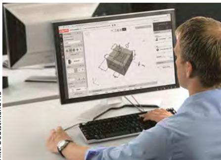
Die „Profis Engineering Suite“ von Hilti ist eine web-basierte Software zur Bemessung von Dübeln in Beton und Mauerwerk und zur Geländerbemessung.
